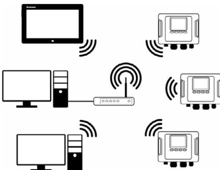
Sonel PQM-710 und Sonel PQM-711 sind mit einem eingebauten **GPS-Empfänger**, der eine hohe Zeitgenauigkeit gewährleistet, und einem integrierten **GSM-Modem**, das die Fernsteuerung von Messungen erleichtert, ausgestattet. Sonel PQM-711 verfügt darüber hinaus über einen **Transientenrekorder** (Abtastrate 10 MHz, Spannungsbereich **bis ±8000 V**).
